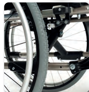
Profondeur d'assise ajustable par déplacement du croisillon
